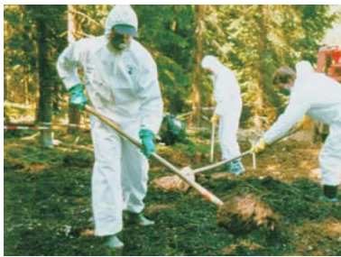
Wissenschaftler verteilen Pilzsubstrat auf einem TNT-verunreinigten Boden
